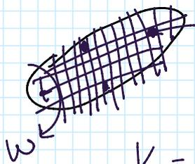
$$\frac{m_i v_i^2}{2} = \frac{m_i \omega_i^2 r_i^2}{2}$$
